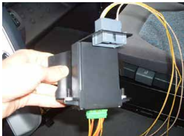
Slika 11: FMS Getaway unit. Vir: Renault Auto Data sistem
